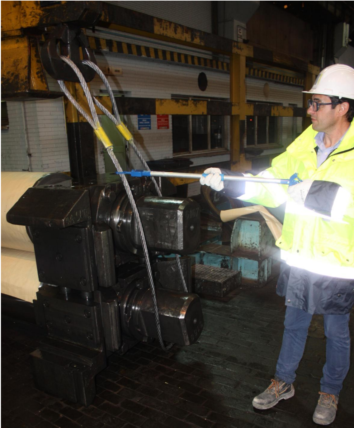
Fig. 1 Manejo de estrobos con la tenaza manual de agarre por resorte.
