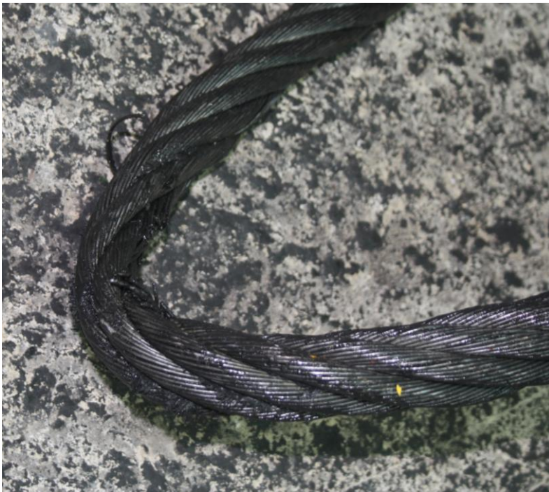
Fig. 6 Detalle del deshilachado de una eslinga de acero.
