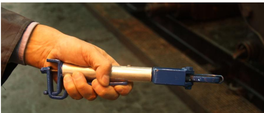
Fig. 3 Posición de la mano para el cierre de la tenaza ultracorta.
