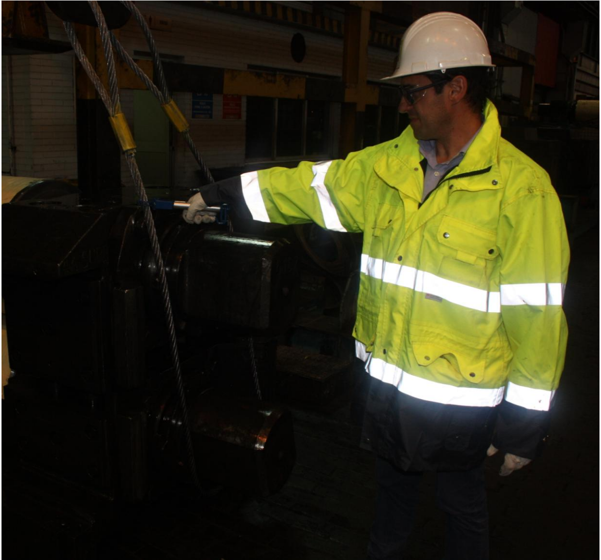
Fig. 2 Manejo de estrobos con la tenaza manual de agarre por resorte ultracorta
